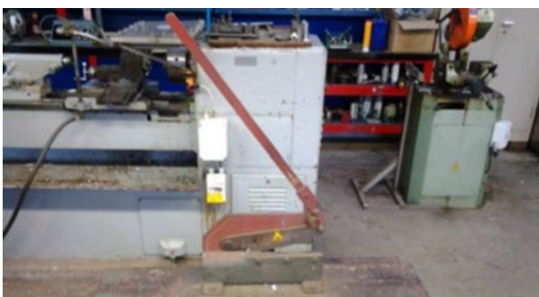
FOTO 2-5 HANDAANGEDREVEN ARBEIDSMIDDEL: KNIPSCHAAR.
