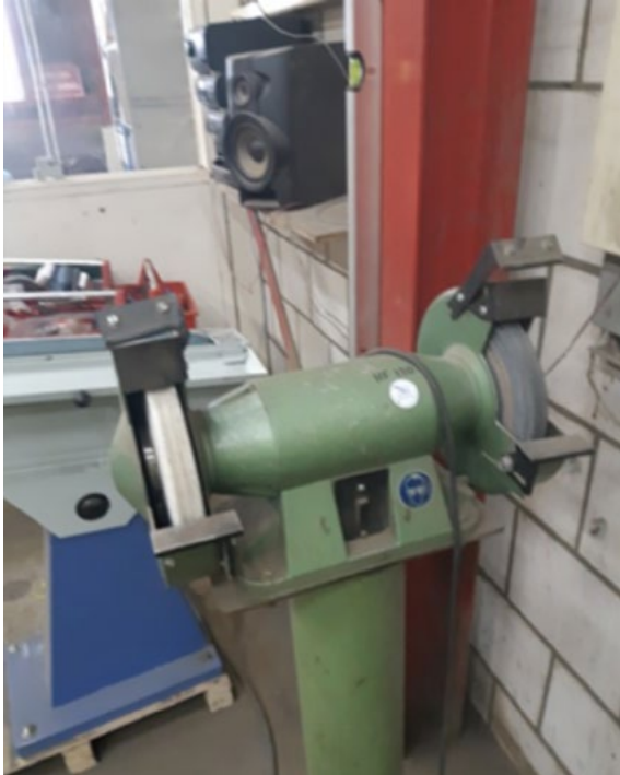
FOTO 2-9 SLIJMACHINE: HET KAN VOORKOMEN DAT DE KEURINGSTICKER AANWEZIG IS OP HET ARBEIDSMIDDEL MAAR DAT DE AFSCHERMINGEN ONTBREKEN. DIT IS EEN ONVEILIGE SITUATIE EN DIENT TE WORDEN HERSTELD.
