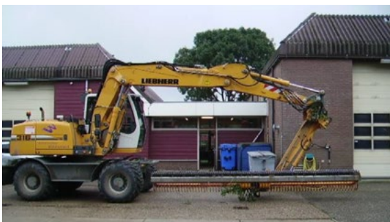
FOTO 2-8 VOERTUIG DAT EEN MAAIWERKTUIG AANDRIJFT.
