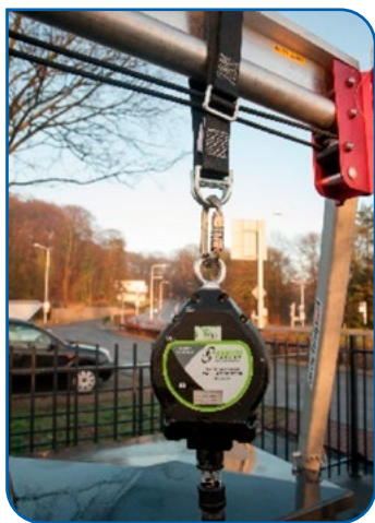
FIGUUR 2-38 VALBLOK MET GEÏNTEGREERDE VALDEMPER EN UITLOPENDE LEEFLIJN
